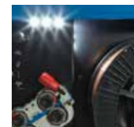
Iluminación LED en el interior del devanador
